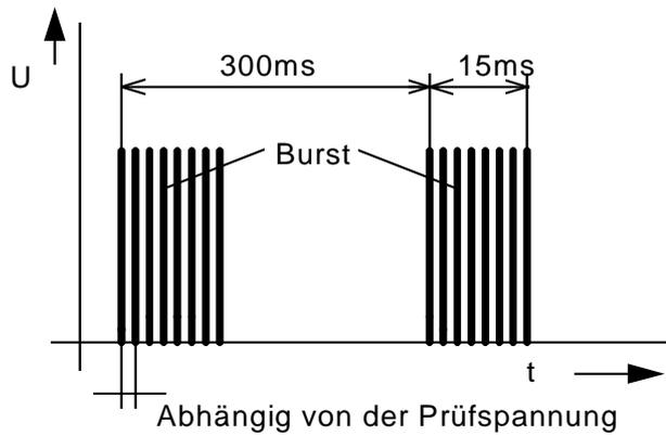
b) Burst Prüfsequenz
