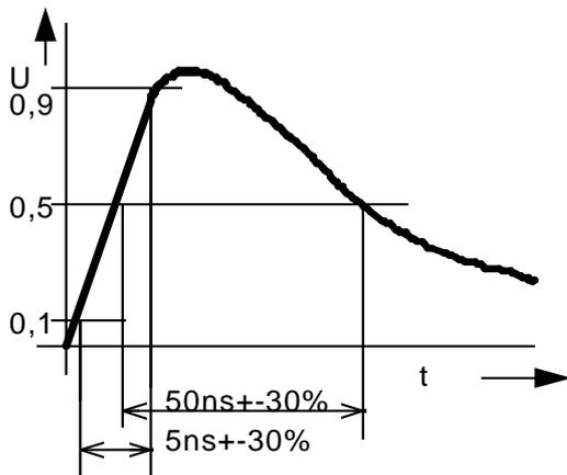
a) Spannungsform gemessen an 50 Ohm
